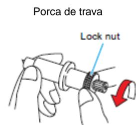
2. Gire o botão de ajuste, para ajustar a extensão da projeção da lâmina do cortador.
