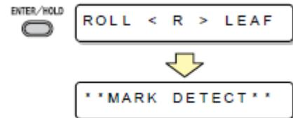
3. Após a detecção das marcas de registro é apresentada a tela de compensação de escala.
