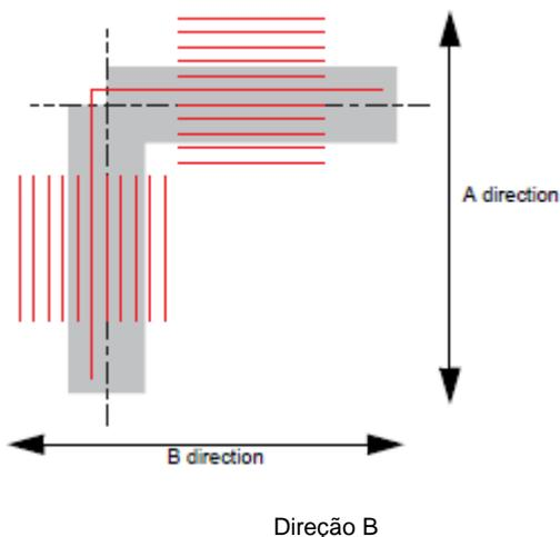
Desalinhado em +0,2mm a partir da linha central da marca de registro (---) na direção A e B.
