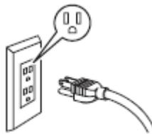
**Com respeito ao uso de tomada bipolar, você deve conectar o adaptador terra auxiliar ao pino do cabo de força.**
